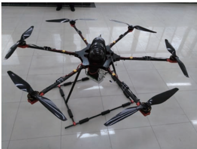
图3 燃料电池动力电源与多旋翼无人机试装
