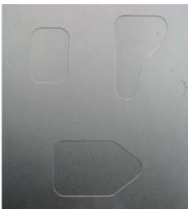
高精密切工艺加工各种形状的TC1和TC4钛合金 (试样大小: 240\text{mm} \times 200\text{mm} \times 2\text{mm} , 化铣深度 0.3\text{mm} )
