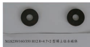
图4 XGS239/160/350H12.8x4.7x2.0 稀土钴永磁材料
