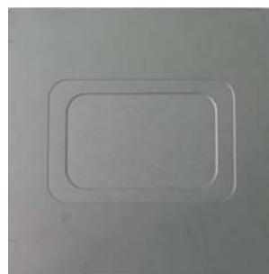
阶梯化铣的TC1和TC4钛合金 试样大小: 150\text{mm} \times 150\text{mm} \times 2\text{mm} , 化铣深度 0.3\text{mm} 和 0.8\text{mm}
