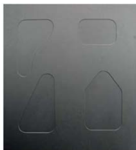
高精密切工艺加工各种形状的TC1和TC4钛合金 (试样大小: 240\text{mm} \times 200\text{mm} \times 2\text{mm} , 化铣深度 0.3\text{mm} )
