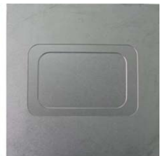
阶梯化铣的TC1和TC4钛合金 试样大小: 150\text{mm} \times 150\text{mm} \times 2\text{mm} , 化铣深度 0.3\text{mm} 和 0.8\text{mm}
